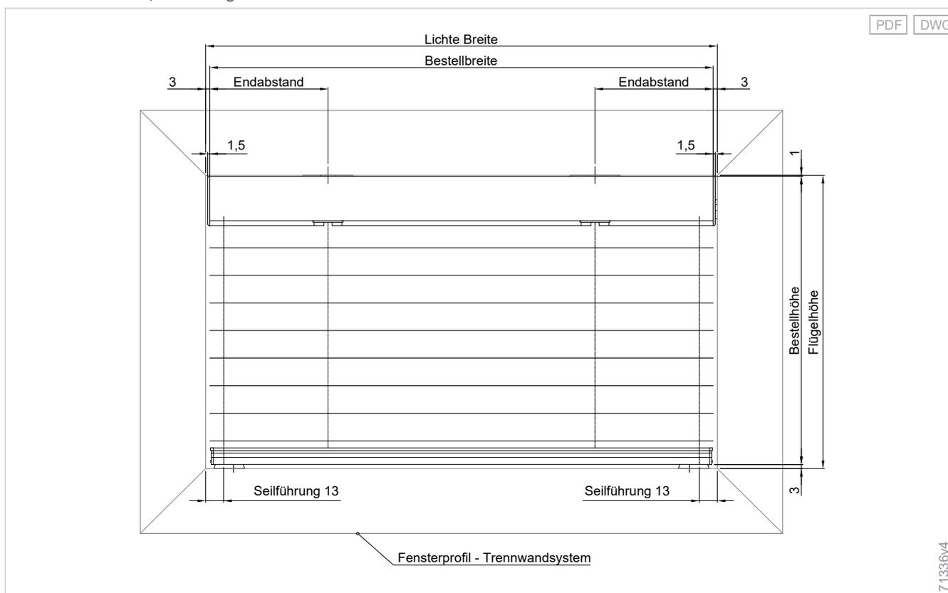
In der Anlagenhöhe ist je nach Einbausituation die untere Spannseilbefestigung zu berücksichtigen.
