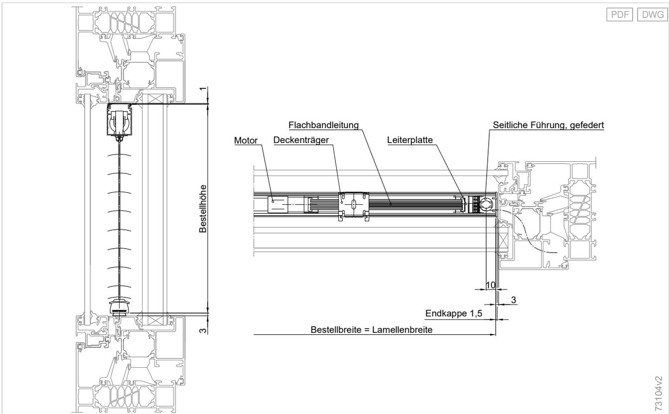
In der Bestellhöhe muss je nach Einbausituation die untere Spannseilbefestigung berücksichtigt werden. Bauseitig ist eine 24-Volt-Kabelzuleitung notwendig. Das Abdeckprofil entspricht der Breite der Oberschiene.
