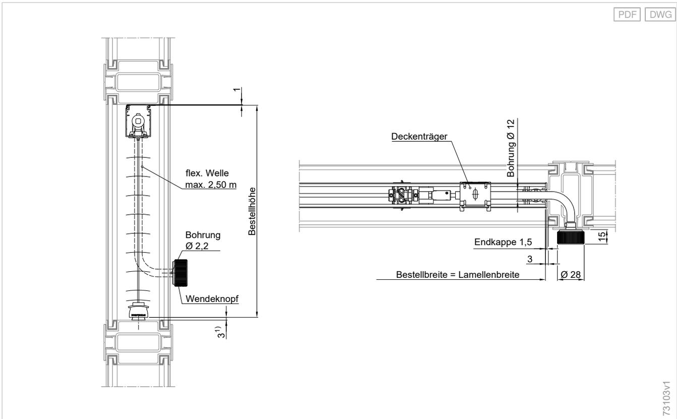
In der Bestellhöhe muss je nach Einbausituation die untere Spannseilbefestigung berücksichtigt werden. Die Lamellen können bei dieser Ausführung nur gewendet werden. Das Hoch- und Tieffahren der Jalousie ist nicht möglich.
