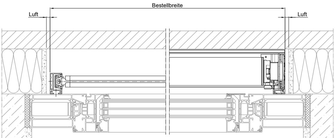
Ausgegraute Darstellungen beschreiben Schnittstellen zu übergreifenden Gewerken, welche generell bauseitig eigenverantwortlich zu planen und zu leisten sind. WAREMA übernimmt für die ausgegraute Schnittstellen keine Leistungen und keine Haftung!
