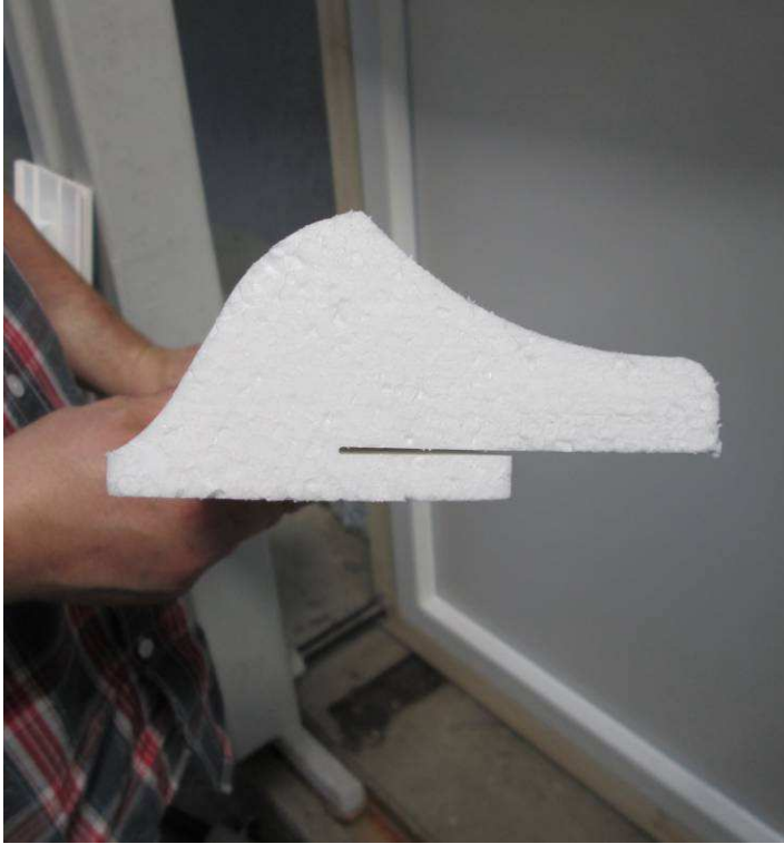
Bild 8 Detail Revisionsdeckeldämmung
