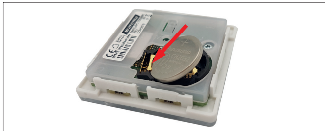
Fig. 6 Insertion de la nouvelle pile
