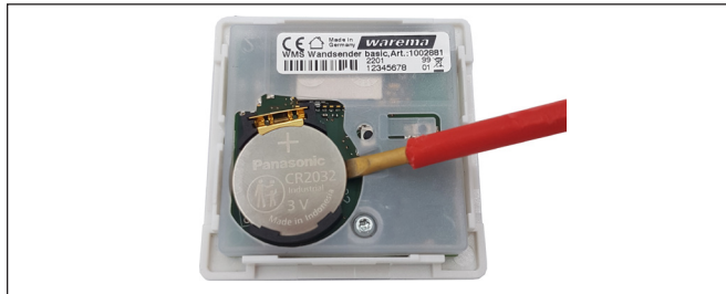
Fig. 5 Extraction de la pile
