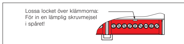
Bild 3 Lossa skyddslocken över klämmorna
